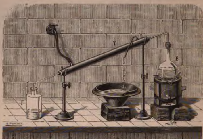
Fig. 155. — Préparation de l'acide cyanhydrique étendu.
